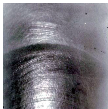
РИС.4. ОТТЕСНЕНИЕ ПОЛИЭТИЛЕНА, ОТМЕЧАЕМОЕ ПОСЛЕ ИСПЫТАНИЯ УЗЛА ТРЕНИЯ ЭНДОПРОТЕЗА ТАЗОБЕДРЕННОГО СУСТАВА
